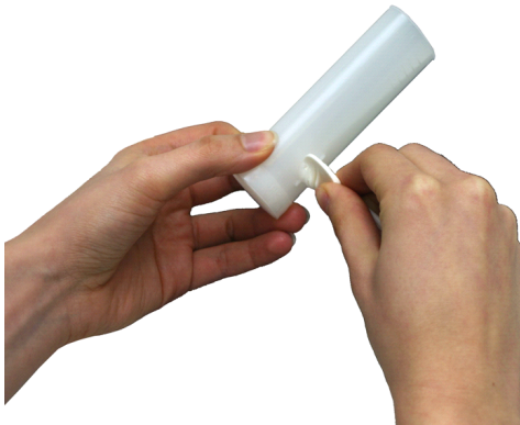
Figura: Installazione del trasduttore di flusso monouso_2
