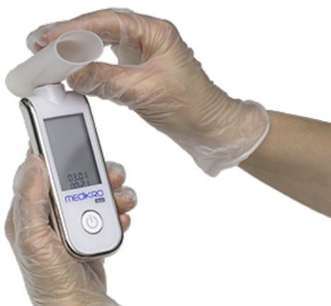
Figura: Installazione del trasduttore di flusso monouso_3
