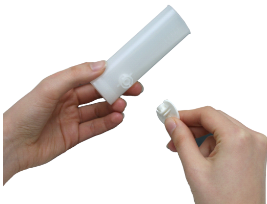
Figura: Installazione del trasduttore di flusso monouso_1
