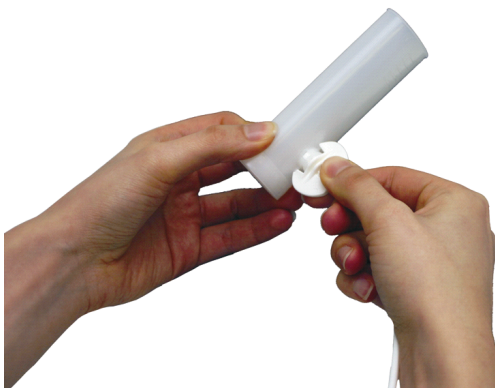
Figura: Installazione del trasduttore di flusso monouso_3
