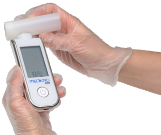
Figura: Installazione del trasduttore di flusso monouso_2
