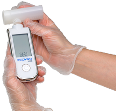
图：一次性流量传感器安装_1
