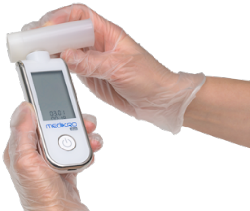
Figura: Instalação_2 do transdutor de fluxo Descartável
