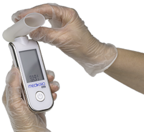
Figura: Instalação_3 do transdutor de fluxo Descartável
