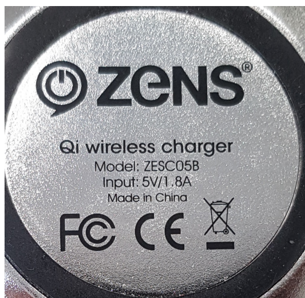
Figur: ZESC05B Qi typeskilt til trådløs oplader
