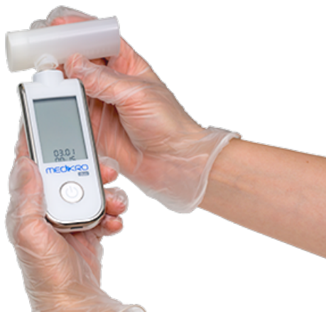
Figura: Montaje del transductor de flujo desechable_1
