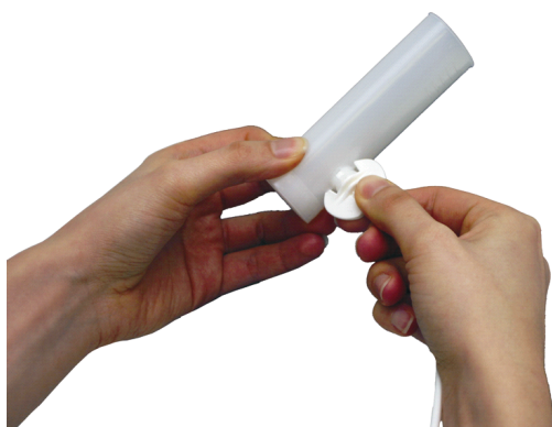
Figura: Instalación del transductor de flujo desechable_3
