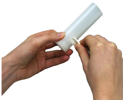
Figura: Instalación del transductor de flujo desechable_2
