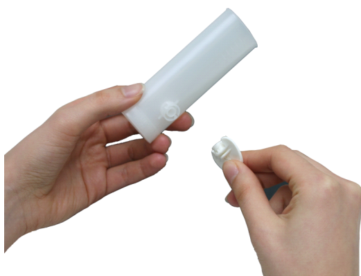
Figura: Instalación del transductor de flujo desechable_1
