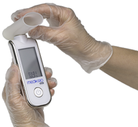
Figur: Engångsflödesgivare installation_3
