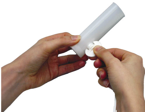
Bild: Installering av flödesgivare för engångsbruk_3
