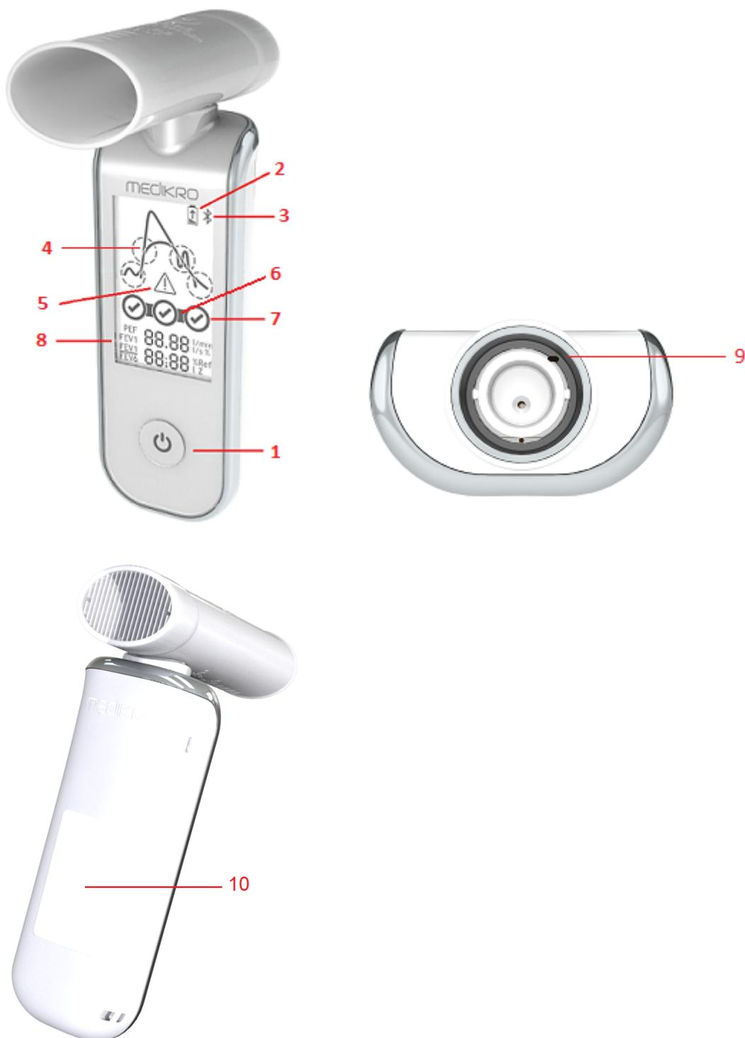
1. **Botão de alimentação:** Ligue o dispositivo (breve pressão) e desligue (pressão prolongada). A breve pressão também impede que o dispositivo se desligue automaticamente.
