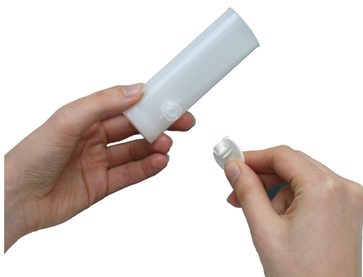
Kuva: Kertakäyttöisen virtausanturin asentaminen (1)
