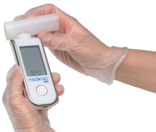
Rysunek: Zakładanie nowego pneumatychu_2
